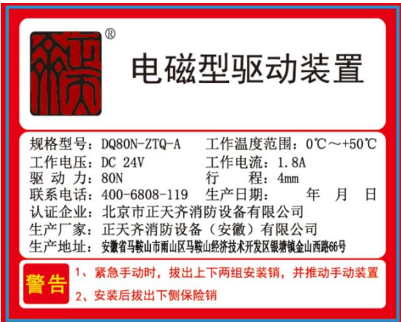
图 12 电磁驱动装置标贴
